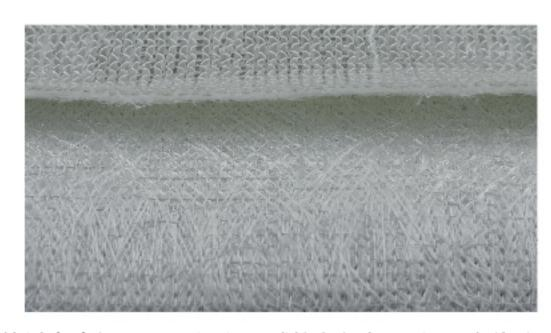
众杰玻璃纤维双轴向夹芯毡是由双轴向织物(0/90° 经编织物)加PP, PET或尼龙芯材为中间层,再加以平铺均匀短切层以聚酯缝编线缝编而成的夹芯织物。适用于各种树脂增强系统,如不饱和聚酯树脂,乙烯基树脂和环氧树脂等。广泛应用于真空,轻质RTM等闭模成型工艺,如造船,风电机舱罩,汽车或火车零部件及其他玻璃钢制品。
