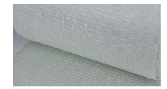
众杰玻璃纤维双轴向经编织物是由无碱玻璃纤维直接纱呈0°/90°定向排列后以聚酯缝编线缝编而成,可选用短切原丝层或无纺布层加工成经编复合毡。适用于各种树脂增强系统,如不饱和聚酯树脂,乙烯基树脂和环氧树脂等。广泛应用于真空,手糊,拉挤,RTM等成型产品,如船体,风电叶片,汽车部件,运动器材及其他玻璃钢制品。
