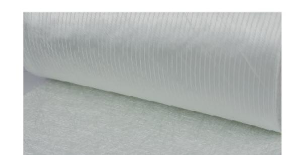
众杰玻璃纤维多轴向织物是由无碱玻璃纤维直接纱呈+45°/−45°定向排列后以聚酯缝编线缝编而成,可选用短切原丝层加工成多轴向经编复合毡。适用于各种树脂增强系统,如不饱和聚酯树脂,乙烯基树脂和环氧树脂等。广泛应用于真空,手糊,拉挤,RTM等成型产品,如船体,风电叶片,汽车部件,运动器材,大型容器及其他玻璃钢制品。
