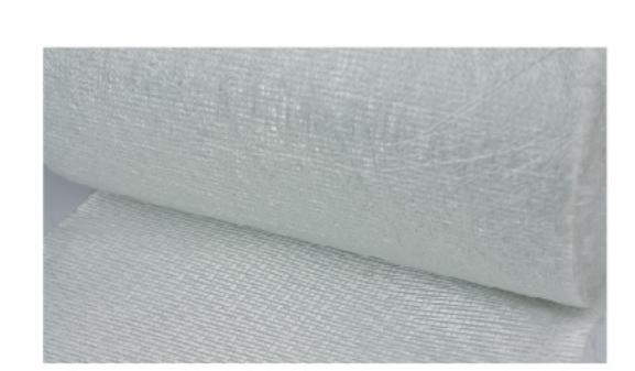
众杰玻璃纤维单纬向织物是由无碱玻璃纤维直接纱以单向90°平行排列,用聚酯缝编线缝编而成,可跟玻璃纤维短切层和无纺布层缝编为复合毡。适用于各种树脂增强系统,如不饱和聚酯树脂,乙烯基树脂和环氧树脂等。广泛应用于拉挤、手糊、RTM等成型产品,如风电,造船,拉挤型材、板材及其他玻璃钢制品。
