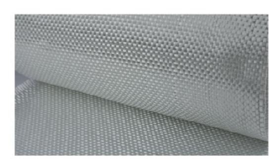
众杰玻璃纤维方格布是由直接无捻粗纱织成的一种平纹或斜纹增强织物,这种结构给予织物使用时优秀的空间稳定性。适用于各种树脂增强系统,如不饱和聚酯树脂,乙烯基树脂和环氧树脂等。广泛应用于手糊和机械成型产品,如船舶、飞机、玻璃钢容器、游泳池、车体、帆板、家具及其他玻璃钢制品。
