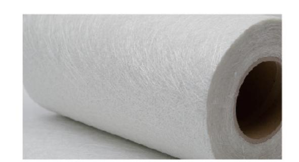
众杰玻璃纤维短切毡是由玻璃纤维短切原丝通过粉末或乳液粘结剂无定向粘结而成。适用于各种树脂增强系统,如不饱和聚酯树脂,乙烯基树脂和环氧树脂等。广泛应用于手糊,缠绕,模压等成型产品,如造船,汽车,冷却塔,卫浴器具,防腐管道及 其他玻璃钢制品。
